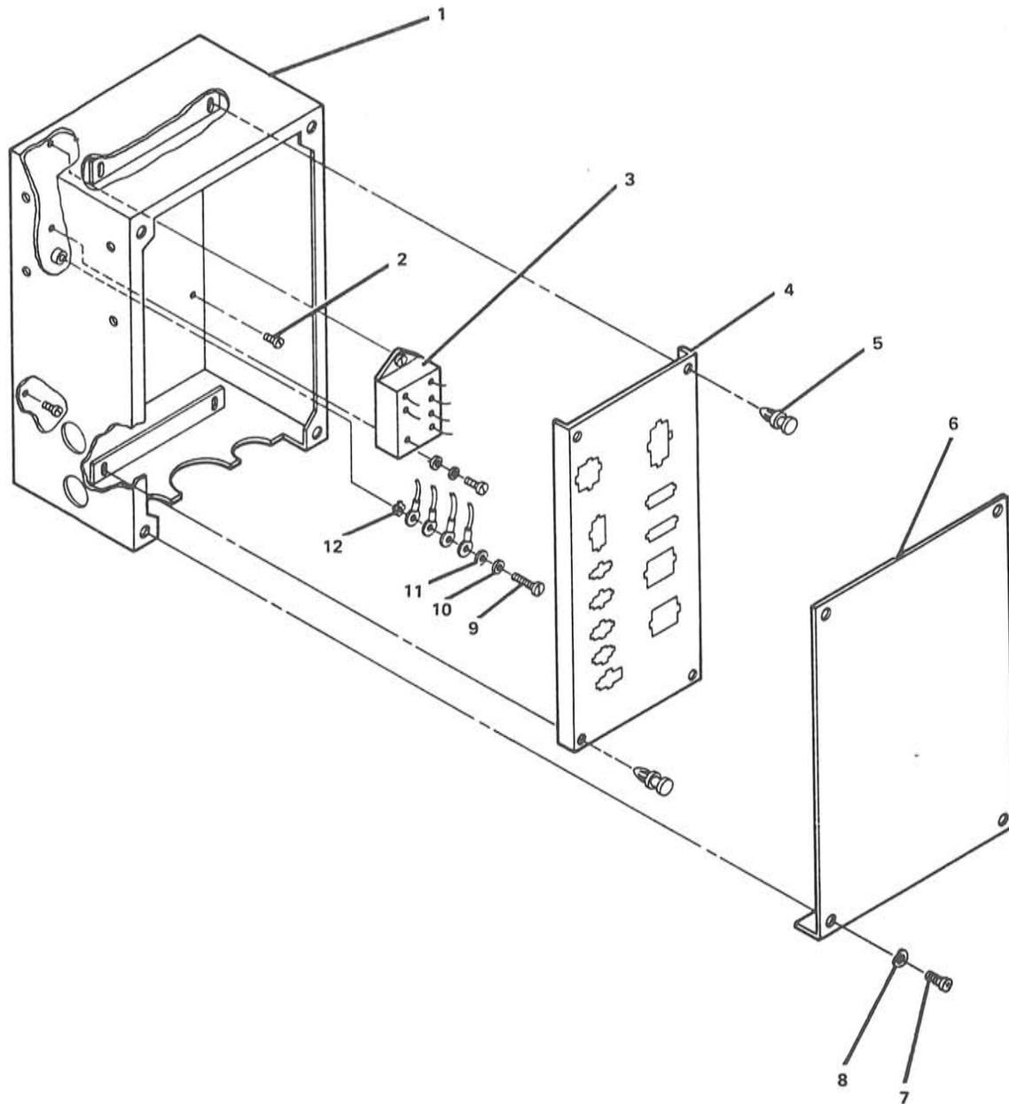
FIGURE 7. OUTLET BOX ASSEMBLY. SEE LIST 7.
