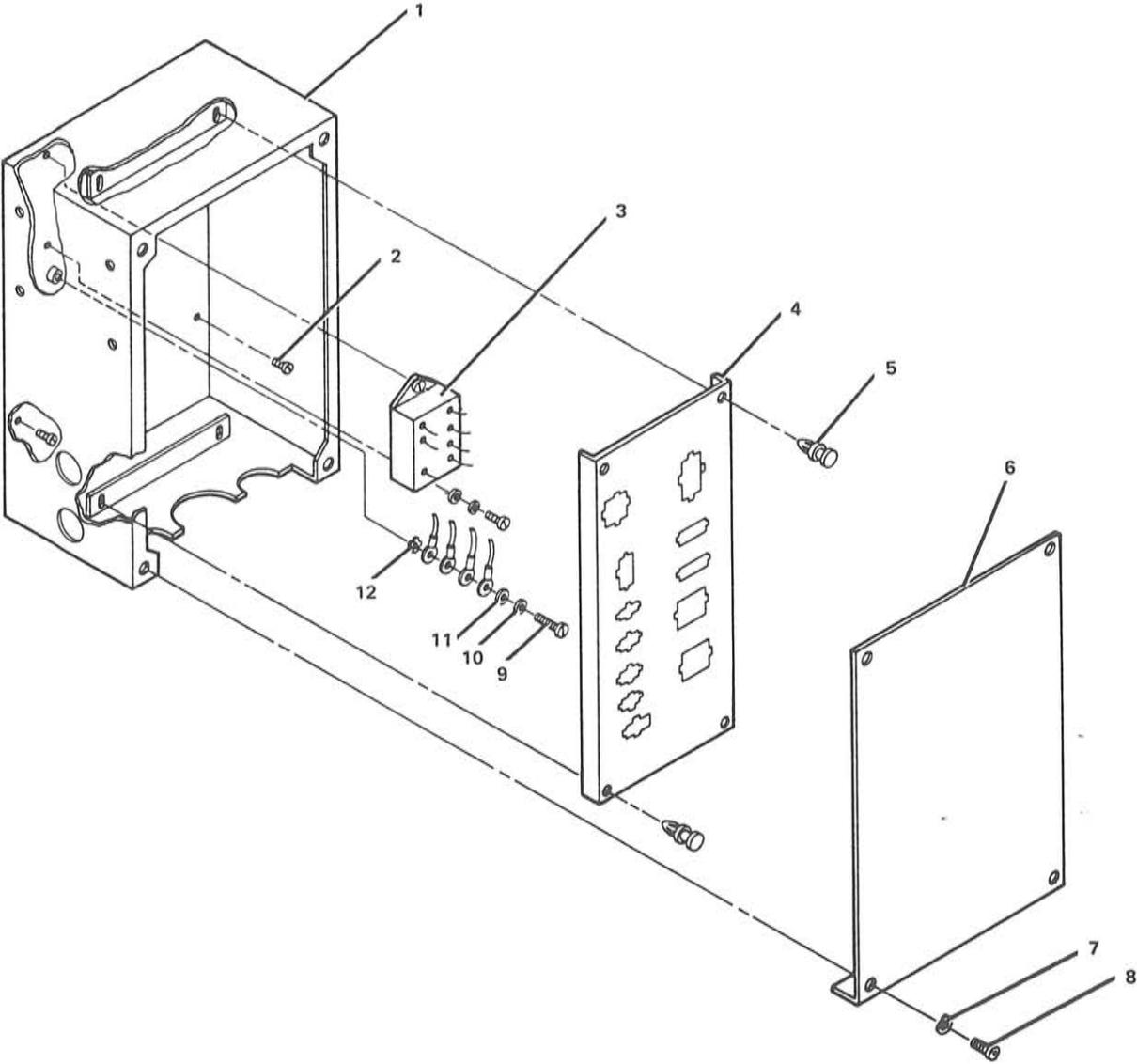
FIGURE 7. OUTLET BOX ASSEMBLY. SEE LIST 7.
